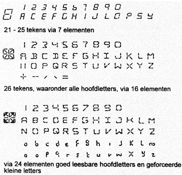
Figuur 17.20 Enkele voorbeelden van alfanumerieke segment-tekens.
