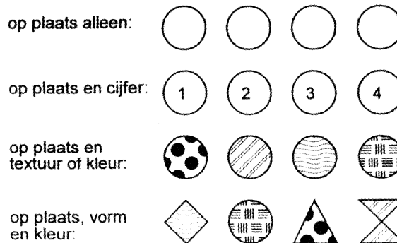
Figuur 16.3 Coderingsmogelijkheden voor vier signaallampen op een wasautomaat.
